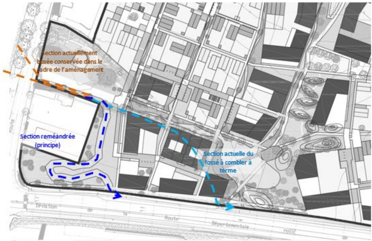
Figure 3: Modifications envisagées au niveau du fossé
