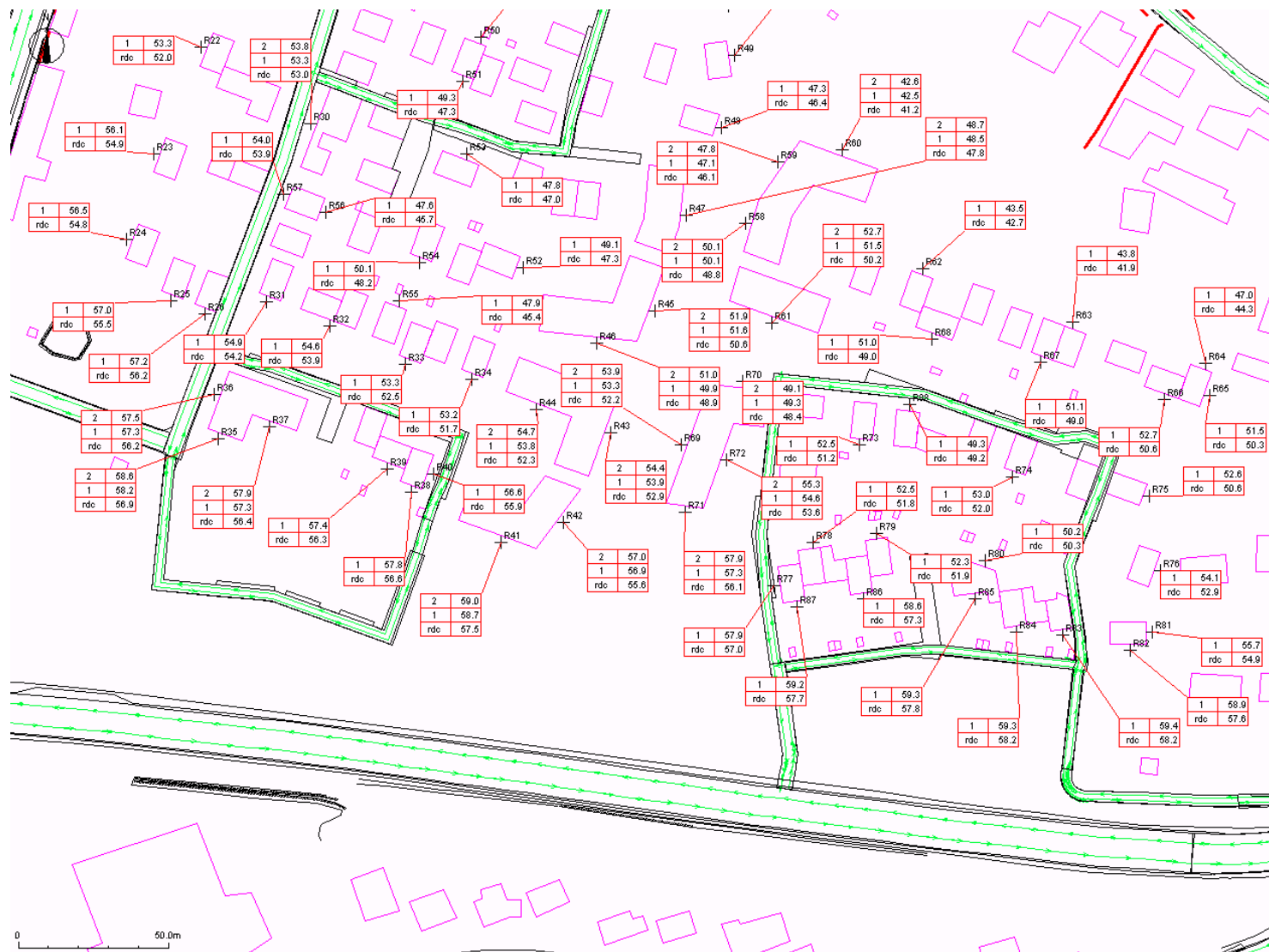
Figure 78 : Carte sur récepteurs sur les bâtiments projetés du secteur de la Jolivetterie – horizon 2028 – tranches 1 et 2- secteur sud
